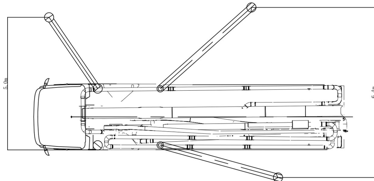
アウトリガー設置寸法及びブーム作業範囲参考図
